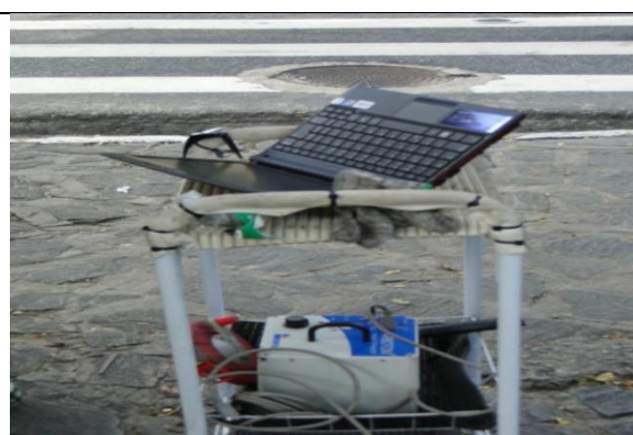
Foto 4 Equipamento para exame de ultrassonografia em árvore em João Pessoa Fonte: DIVAR/DCA/SEMAM/PMJP, 2021
