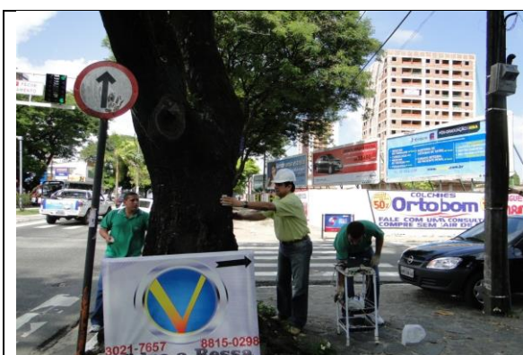
Foto 3 Técnico realizando exame de ultrassonografia para verificação da saúde em árvore em João Pessoa Fonte: DIVAR/DCA/SEMAM/PMJP, 2021
